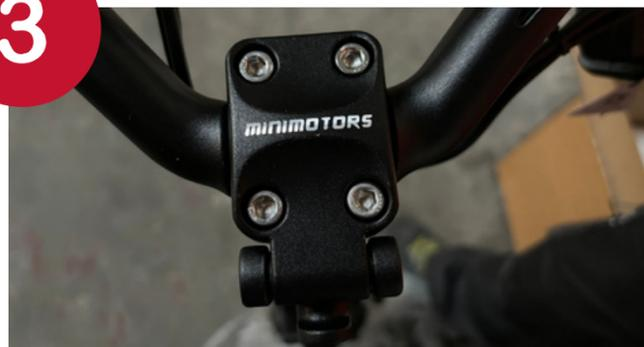
Mettre en place le guidon sur la colonne de direction
