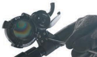
Positionner l'afficheur et fixer les vis
